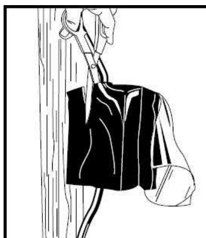
4. Knip of snij al het overige materiaal weg. Uw brandwerende wandcontactdoos is gereed.
